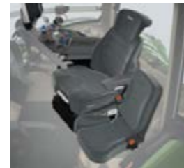
Il sedile super comfort Evolution dynamic è dotato di sospensioni pneumatiche e di una climatizzazione attiva, nonché di un'estensione dello schienale.
