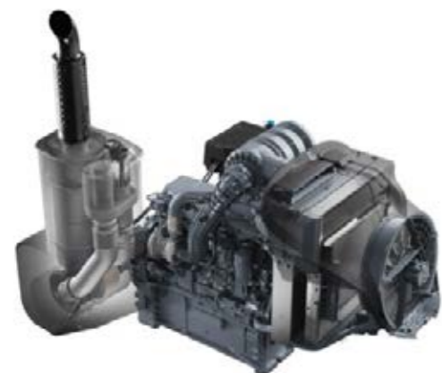
Il motore 12.4 l MAN con Common Rail raggiunge una pressione d'iniezione elevata di 1.800 bar ed è quindi molto efficiente.
