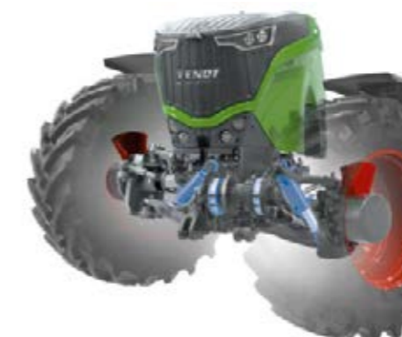
Assale anteriore con sospensione e freno singoli delle ruote e regolazione di livello.
