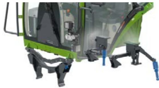
La sospensione meccanica della cabina è posizionata anteriormente su due cuscinetti a cono e posteriormente su due elementi a molla meccanici.
