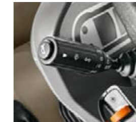
Come ogni Fendt, anche il Fendt 1000 Vario rende la giornata di lavoro più facile grazie a piccoli dettagli pratici come il reset automatico dell'indicatore di direzione: il trattore segnala automaticamente la svolta fino a quando questa giunge a termine.
