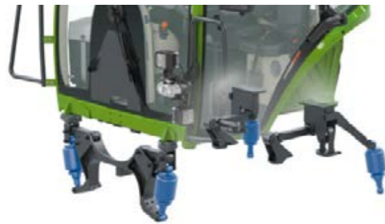
La cabina è dotata di sospensione pneumatica quadrupla comfort, con regolazione di livello integrata, che riduce al minimo le vibrazioni.
