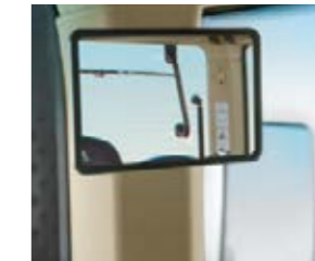
Grazie a uno specchietto retrovisore interno, l'operatore ha sempre sotto controllo l'attrezzo di lavoro.
