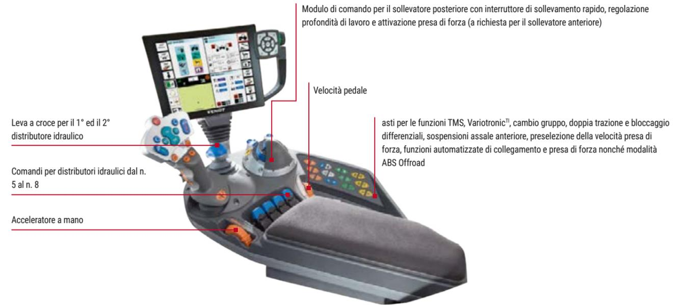
Leva a croce per il 1° ed il 2° distributore idraulico
