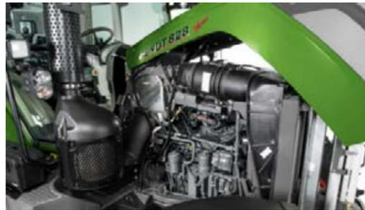
Il cofano oscillante e i pannelli laterali facilmente removibili consentono un accesso molto agevole al vano motore.
