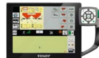
Il controllo attrezzi ISOBUS è perfettamente integrato nel terminale Vario da 7" e da 10,4". L'attrezzo viene controllato con il terminale e il joystick e non è richiesto un terminale supplementare.
