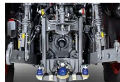
I collegamenti inferiori sul sollevatore posteriore possono essere richiusi in posizione di parcheggio, affinché vi sia dello spazio in più per la barra forata.
