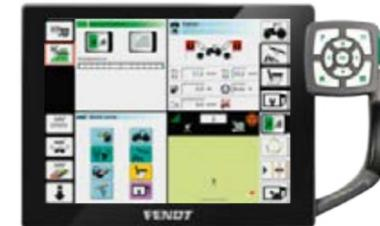
Se necessario, le funzioni di controllo attrezzi ISOBUS e gestione capezzagna possono essere assegnate alla leva multifunzione. In combinazione con il sistema di guida parallela VarioGuide, Variotronic<sup>TM</sup> automatic consente di attivare automaticamente le sequenze in capezzagna.
