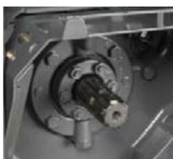
La presa di forza vanta un'eccezionale efficienza poiché la potenza viene trasferita direttamente dal cambio Vario all'albero della presa di forza. Al contempo le velocità nominali si raggiungono già a un regime del motore inferiore a 2.000 giri/min, con il vantaggio di ridurre i consumi di carburante.
