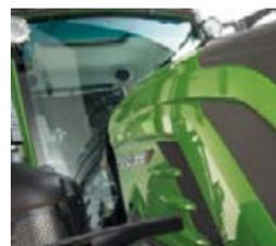
□ Nei Fendt i finestrini della cabina sono incollati, non serrati. In questo modo non solo la visuale dell'operatore risulta migliore, ma soprattutto si evitano scricchiolii e infiltrazioni. È anche riscaldata.
