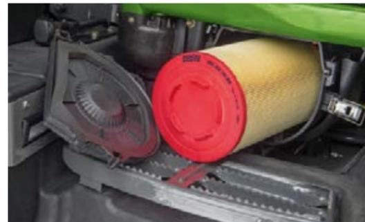
Il filtro della cabina è posizionato in un punto facilmente raggiungibile nell'area della porta per poter essere pulito facilmente al bisogno
