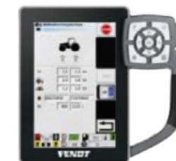
Dal terminale Vario, la pressione degli pneumatici può essere controllata semplicemente premendo un tasto. Il sistema di assistenza informa l'operatore se la pressione è eccessiva o insufficiente.
