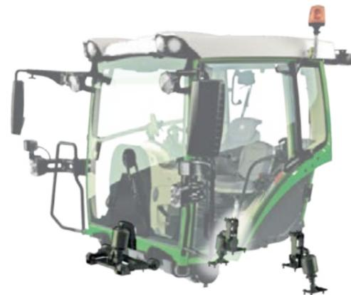
□ La sospensione della cabina con elementi pneumatici consente di ridurre al minimo le vibrazioni interne. La notevole differenza d'altezza e la distanza tra gli elementi della sospensione della cabina X5 impediscono inoltre fenomeni di beccheggio per un comfort di guida di altissimo livello.
