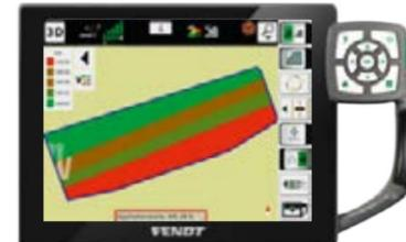
Con VariableRateControl (VRC), è possibile lavorare in base a mappe applicative specifiche del sito agricolo, in base al terreno e al raccolto. In questo modo, è possibile risparmiare sugli input.
