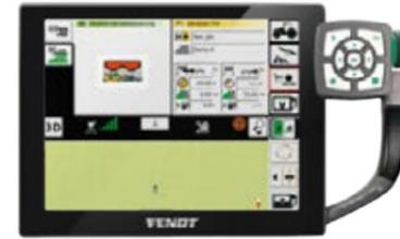
VarioDoc consente la trasmissione wireless dei dati dal terminale Vario al database gestionale. VarioDoc Pro registra costantemente i dati sulla posizione e sulla macchina e il trasferimento avviene mediante rete mobile.
