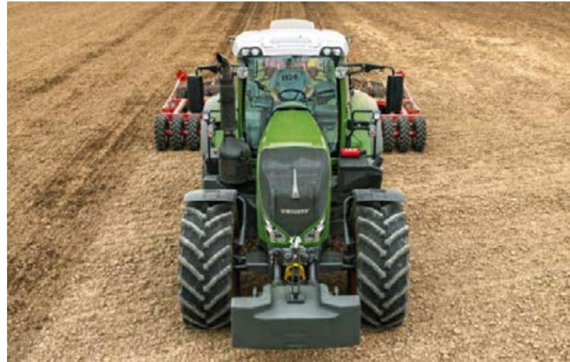
Il Fendt 800 Vario è stato progettato per una visibilità ottimale. Il cofano è stato mantenuto il più stretto possibile, in modo che l'operatore abbia una vista eccellente sui passaruota e gli attrezzi frontali.
